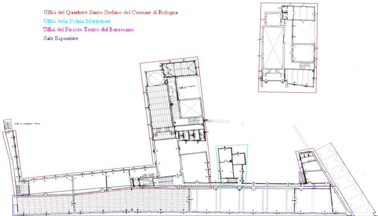
Fig.4 - Pianta piano primo e relative destinazioni d'uso
