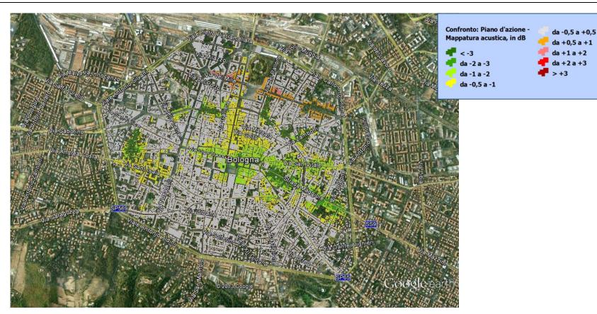
Figura 62. Interventi all'interno del centro storico del Comune di Bologna. Confronto tra livelli  $L_{den}$  simulati in facciata agli edifici: "Piano d'azione" - "Mappatura acustica" (simulazioni comprendenti tutte le sorgenti).
