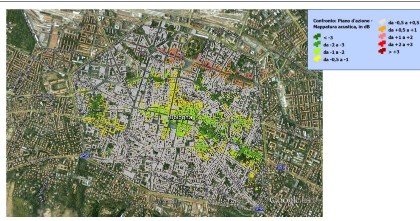
Figura 63. Interventi all'interno del centro storico del Comune di Bologna. Confronto tra livelli  $L_{\text{night}}$  simulati in facciata agli edifici: "Piano d'azione" - "Mappatura acustica" (simulazioni comprendenti tutte le sorgenti).
