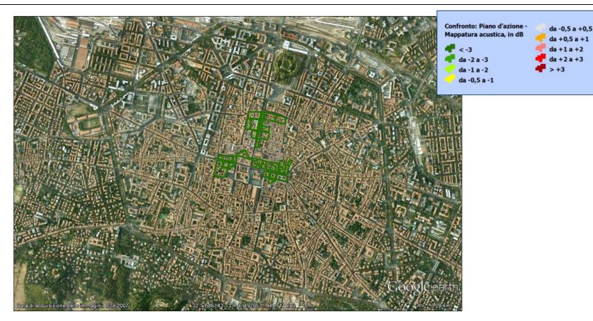
Figura 79. Pedonalizzazione in configurazione "T-Days". Confronto tra indicatori  $ECU_{den}$ : "Piano d'azione" - "Mappatura acustica" (simulazioni comprendenti tutte le sorgenti).
