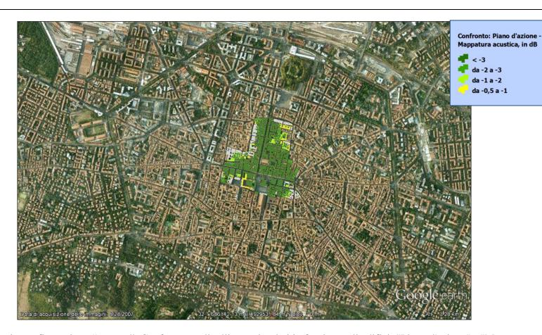
Figura 77. Pedonalizzazione in configurazione "T-Days". Confronto tra livelli  $L_{den}$  simulati in facciata agli edifici: "Piano d'azione" - "Mappatura acustica" (simulazioni comprendenti tutte le sorgenti).
