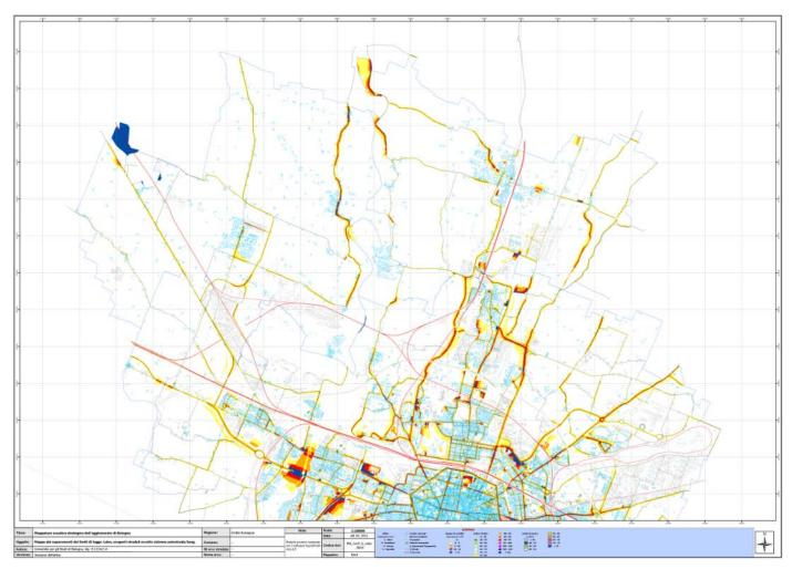
Figura 46. Agglomerato, riquadro Sud. Mappa di conflitto globale sul territorio in termini di  $L_{\text{den}}$  in dB(A), simulazione comprendente le sorgenti stradali ad eccezione del sistema autostrada/tangenziale.
