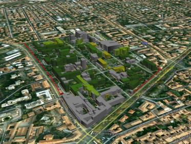
Figura 74. Realizzazione di barriere acustiche a protezione degli edifici del Policlinico S.Orsola – Malpighi. Confronto tra livelli  $L_{den}$  simulati in facciata agli edifici: "Piano d'azione" - "Mappatura acustica" (simulazioni comprendenti tutte le sorgenti).
