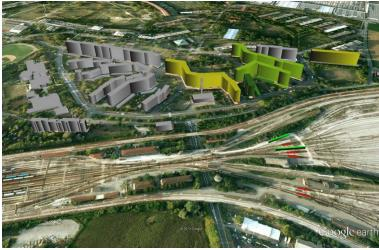
Figura 71. Realizzazione di barriere acustiche a protezione degli edifici residenziali situati in prossimità dello scalo merci ferroviario "San Donato". Confronto tra livelli  $L_{den}$  simulati in facciata agli edifici: "Piano d'azione" - "Mappatura acustica" (simulazioni comprendenti tutte le sorgenti).
