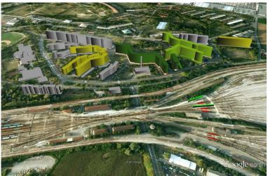
Figura 72. Realizzazione di barriere acustiche a protezione degli edifici residenziali situati in prossimità dello scalo merci ferroviario "San Donato". Confronto tra livelli  $L_{\text{night}}$  simulati in facciata agli edifici: "Piano d'azione" - "Mappatura acustica" (simulazioni comprendenti tutte le sorgenti).
