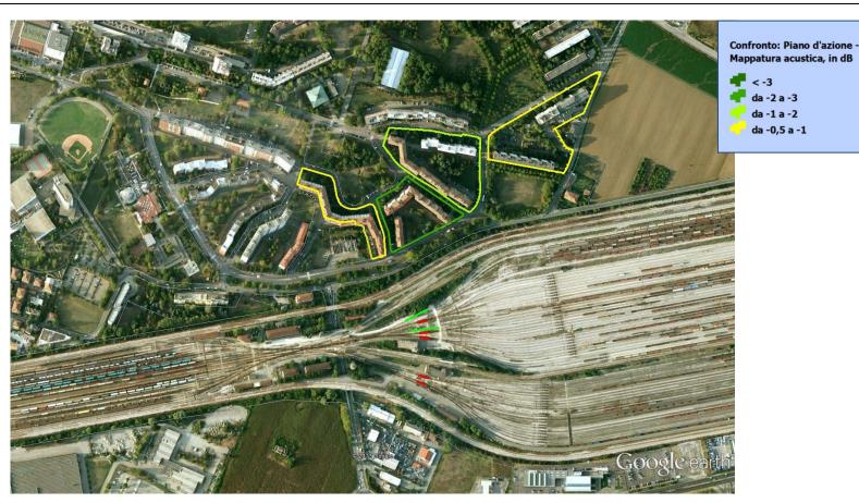
Figura 73. Realizzazione di barriere acustiche a protezione degli edifici residenziali situati in prossimità dello scalo merci ferroviario "San Donato". Confronto tra indicatori ECU<sub>den</sub>: "Piano d'azione" - "Mappatura acustica" (simulazioni comprendenti tutte le sorgenti).
