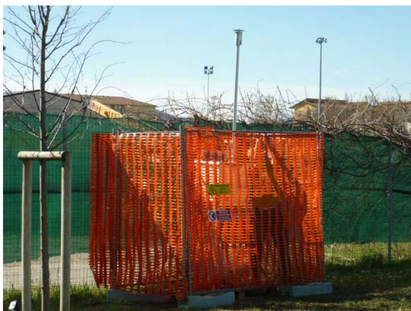
Foto 2– Apparecchiatura installata per il campionamento polveri
