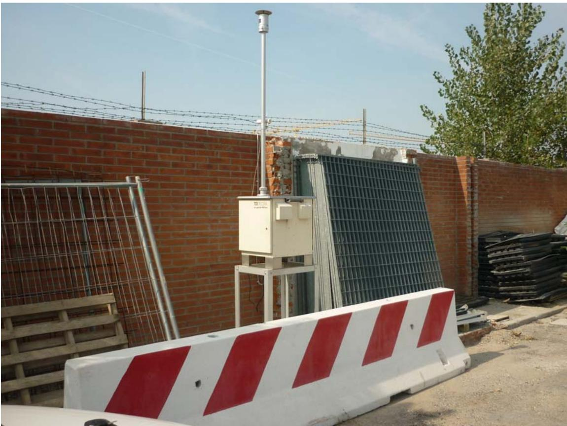
Foto 2– Apparecchiatura installata per il campionamento polveri
