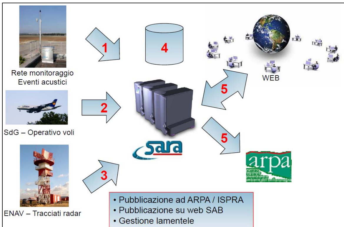
Img. 2.3 – Schema di funzionamento del sistema di monitoraggio del rumore aeroportuale
