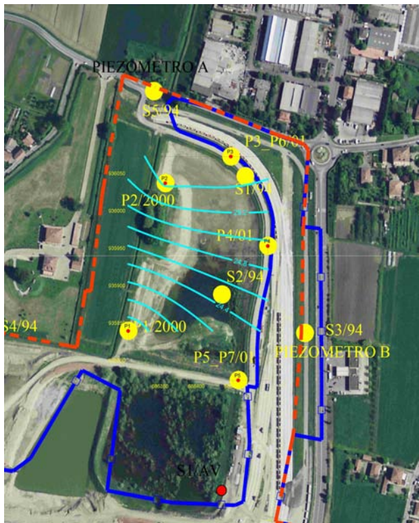
Fig. 27: andamento piezometrico della falda SUP3 – Marzo 2005
