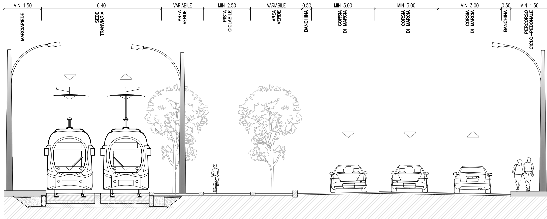
SEZIONE 27 Tramvia a doppio binario in sede laterale carreggiata a doppio senso di marcia su un lato
