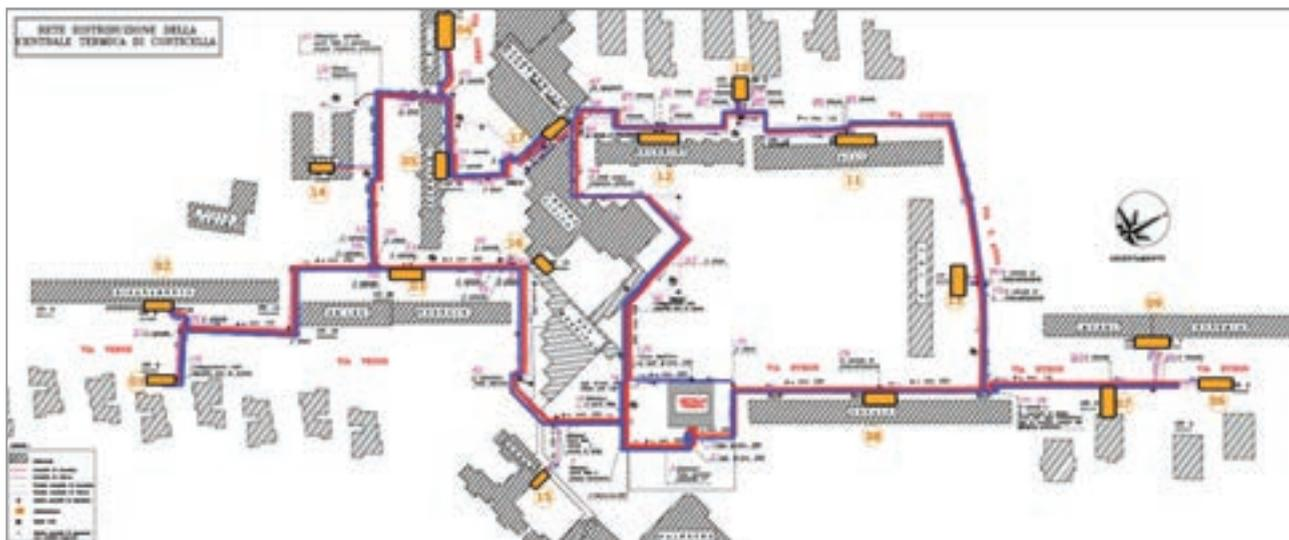
Figura 2 - Rete di teleriscaldamento del quartiere PEEP Corticella
