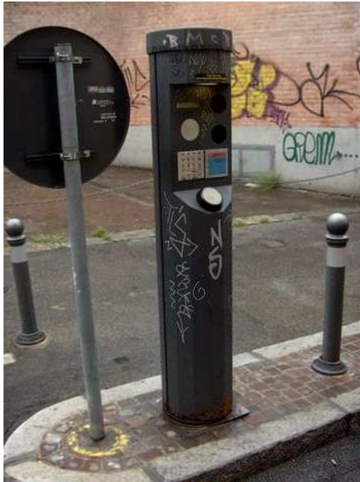
Figura 2: esempio di "colonnina" di automazione interfaccia utente e telecontrollo (Moline/Mentana – entrata)
