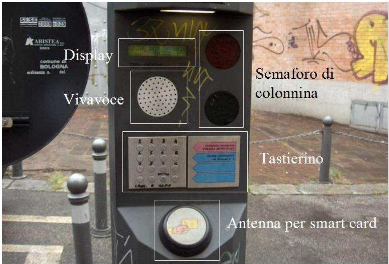
Figura 3: zoom esempio di pannello di interfaccia utente su "colonnina" (Moline/Mentana – entrata)
