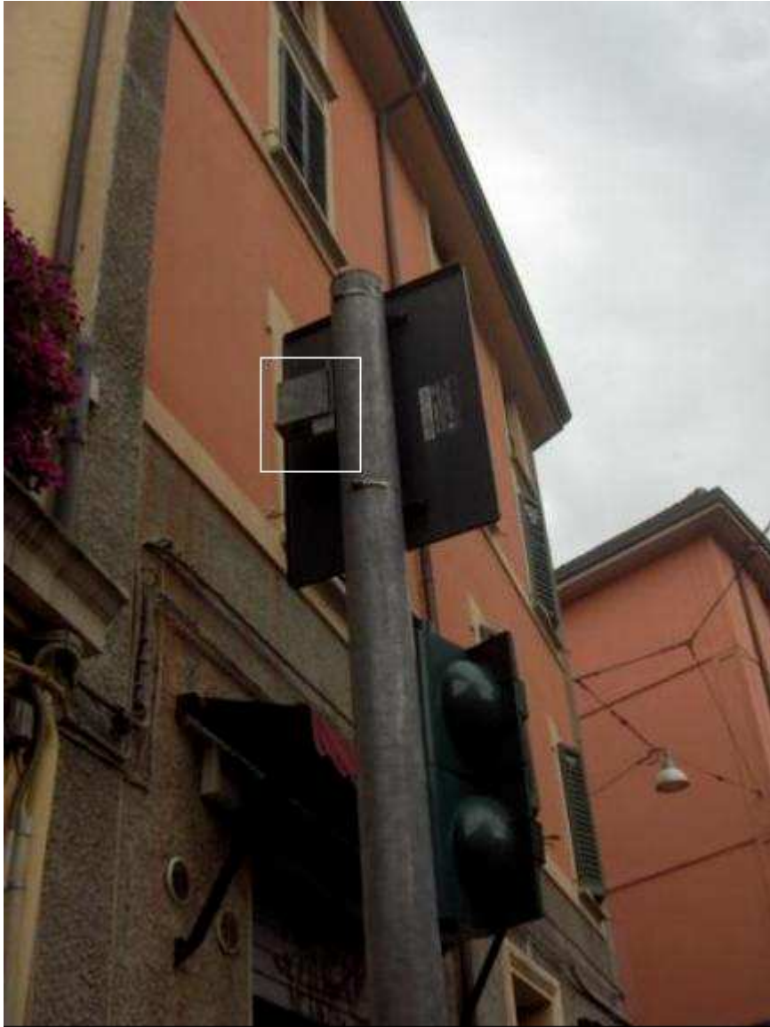
Figura 13: esempio sensore vibrofonico su palo lanterna semaforica e cartello (Moline/Mentana – entrata)
