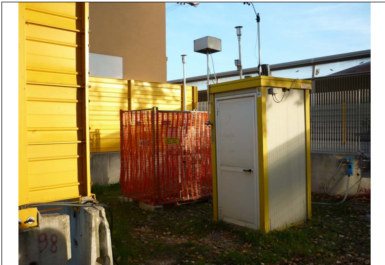
Figura 3–I campionatori di polveri installati: a sinistra quello di ARPA a destra quello di Italferr.
